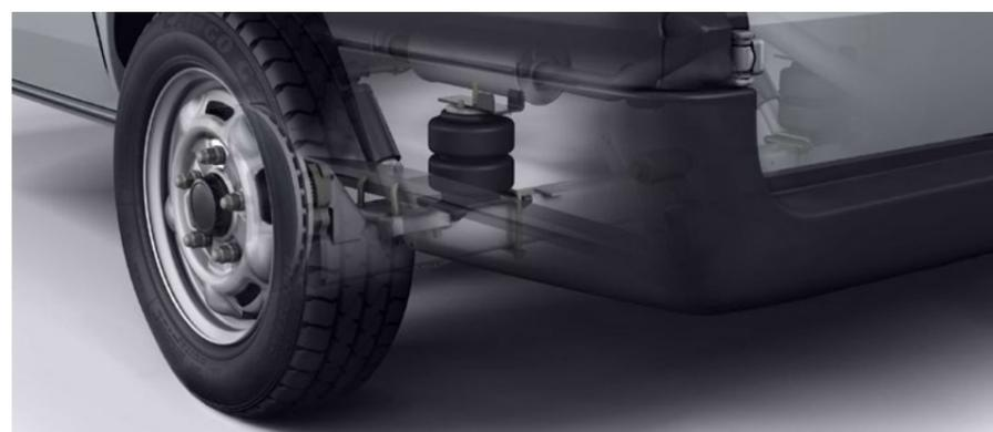
NOTRE SYSTÈME "PLUG-AND-PLAY" PERMET DE MONTER RAPIDEMENT LE RENFORT PNEUMATIQUE ET OFFRE UNE POSITION ROULANTE SURÉLEVÉE AINSI QU'UNE FORCE ÉLASTIQUE VARIABLE.
